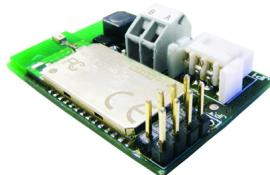
Zusatzkarte für Steuerung zur Bedienung des Antriebs via Smartphone mit Betriebssystem Android (max. 16 Smartphones)
