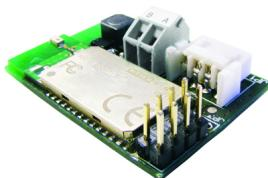
Zusatzkarte für Steuerung zur Bedienung des Antriebs via Smartphone mit Betriebssystem Android (max. 8 Smartphones)
