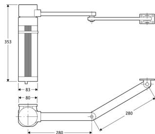
Elektromechanischer Drehtorantrieb bis zu 2,00 m Torflügel
