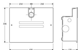
Elektromechanischer Unterflurantrieb 24V bis max. 3,5 m Flügellänge und 400 Kg.
