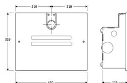
Elektromechanischer Unterflurantrieb 230V bis max. 2,00 m Flügellänge und 150 Kg.
