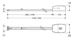
Selbsthemmender Antriebskopf für Sektionaltore sowie Schwingtore mit Führungen und Federausgleich bis 120Kg Torgewicht.
