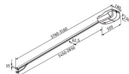
Der Sektionaltorantrieb Tiziano ist mit 13 cm Höhe einer der kompaktesten Garagentorantriebe mit einer Zugkraft von 60Kg
