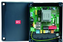
Steuerung für einen Antrieb PEGASO B CJA dreiphasig
