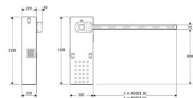
Elektromechanische Schranke (max. Absperrbreite 3,00 m) mit integrierter Steuerung LEO MV D
