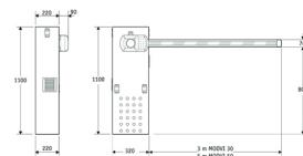
Elektromechanische Schranke (max. Absperrbreite 3,00 m) mit integrierter Steuerung LEO MV D
