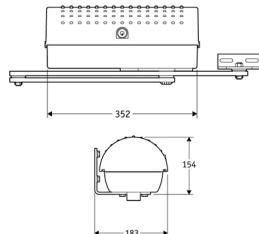
Elektromechanischer 24 V-Drehtorantrieb mit Gelenkarmen und abschließbarer Notentriegelung.
