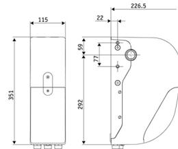
24 V elektromechanischer Sektionaltorantrieb für Tore bis max. 20 m<sup>2</sup> Torfläche im industriellen Einsatz.
